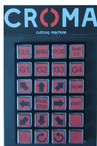
Réglage de la vitesse, pilotage du plateau tournant dans les deux sens, démarrage / interruption / arrêt de la découpe, remise en place du fil selon les positions mises en mémoire dans la machine.
