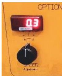
Réglage possible en cours de découpe de la vitesse d'avance du fil, en la faisant varier de -50% à +50% de la vitesse initiale.
